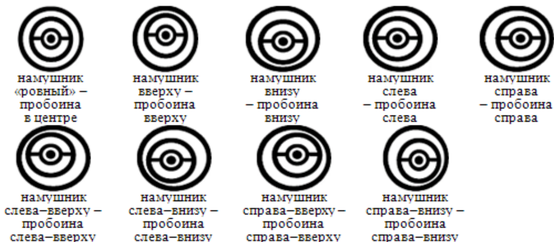
Рисунок 38 – Варианты расположения намушника с кольцевой мушкой внутри диоптра и направления отклонений пробоин от центра
