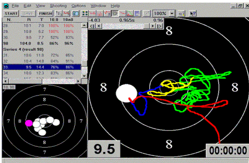
Рисунок 15 – Микроструктура техники выстрела на стрелковом тренажере «Скатт» (зеленая линия: от 8,0 до 1,0 сек; желтая: от 1,0 до 0,2 сек; синяя: от 0,2 до 0,0 сек до выстрела)
