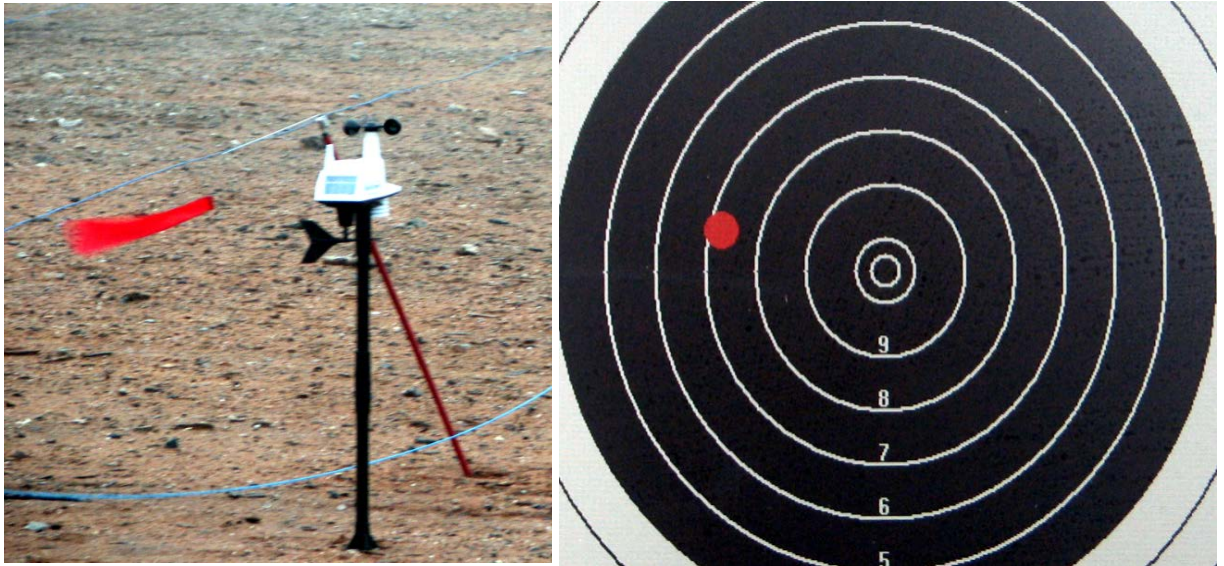
Рисунок 47 – Положение флажков, соответствующее сильному порыву и экран устройства WindTrainer, показывающий отклонение пули при сильном порыве ветра
