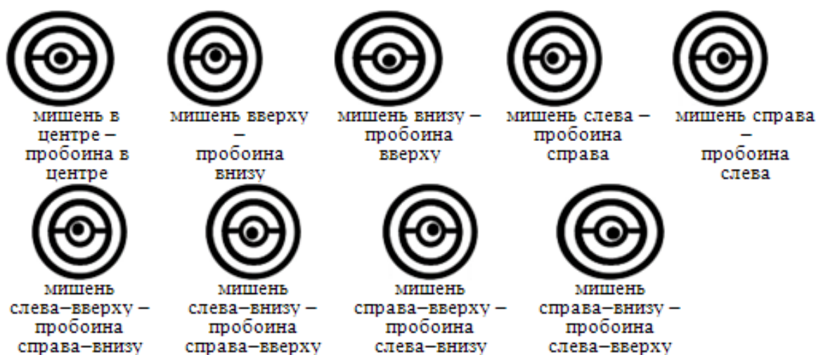
Рисунок 39 – Варианты расположения мишени внутри кольцевой мушки и направления отклонений пробоин от центра
